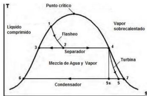
Figura 2.8 Diagrama T-S de un ciclo con flasheo simple. [35]
