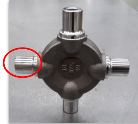
Figura 51. Muñón con mal acabado por inserto desgastado. Fuente: Elaboración propia
