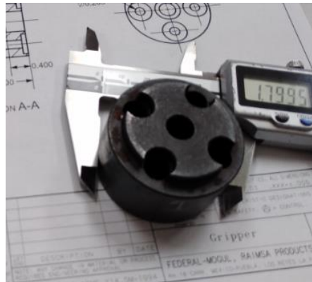
Figura 86. Herramental mordaza manufacturado de acuerdo al plano. Fuente: Elaboración propia
