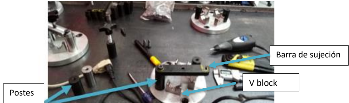
Figura 37. Herramientales para máquina Robodrill . Fuente: Elaboración propia
