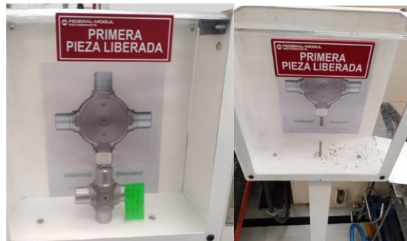
Figura 7. Ayuda visual de como colocar cruceta en un perno y caja después de una mejora en la planta Federal-Mogul, Los Reyes. Fuente: Elaboración propia
