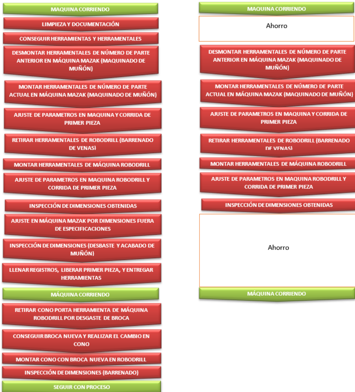
Figura 103. Comparativa del proceso de set-up antes y después de las mejoras. Fuente: Elaboración propia
