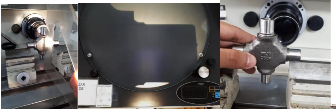
Figura 40. Medición de especificaciones obtenidas en comparador. Fuente: Elaboración propia
