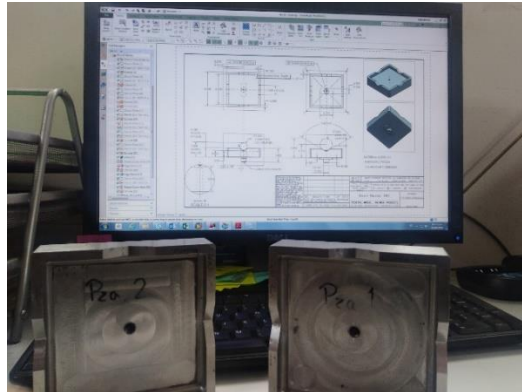
Figura 84. Base 381 fabricada de acuerdo al plano de fabricación. Fuente: Elaboración propia
