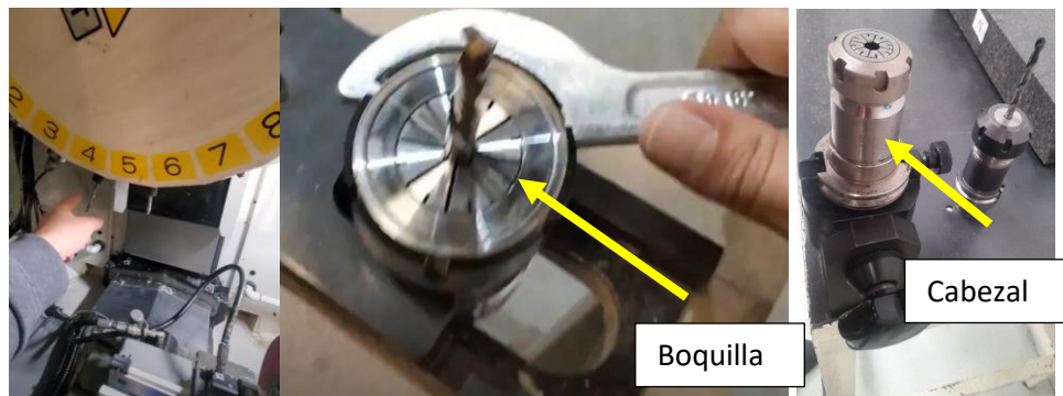
Figura 50. Proceso de cambio de broca de máquina Robodrill. Fuente: Elaboración propia
