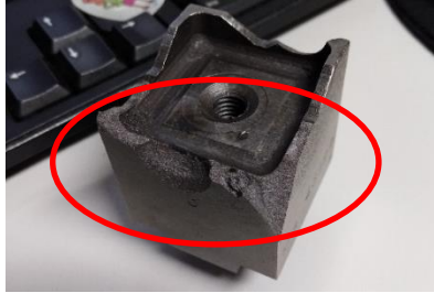
Figura 72. Base fracturada debido a la carga aplicada en torno Mazak. Fuente: Elaboración propia
