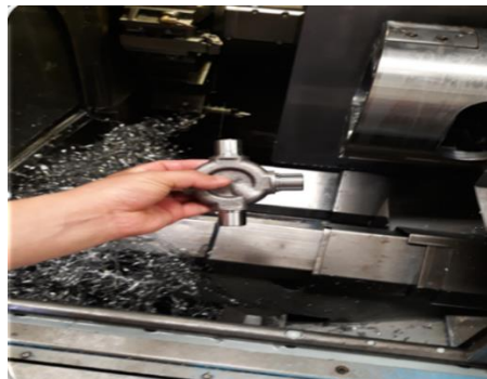
Figura 39. Cruceta maquinada y lista para inspeccionar especificaciones. Fuente: Elaboración propia
