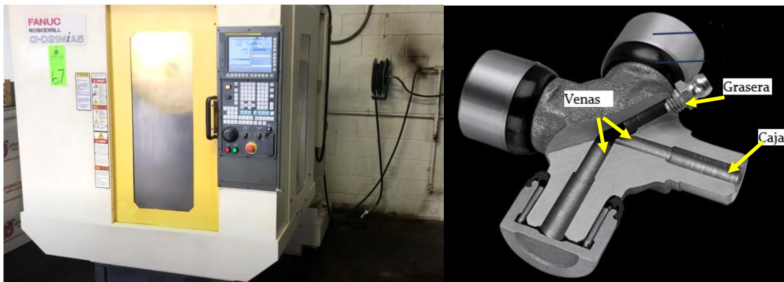
Figura 26. Proceso de barrenado en centro de maquinado CNC "Robodrigill". Fuente: Elaboración propia
