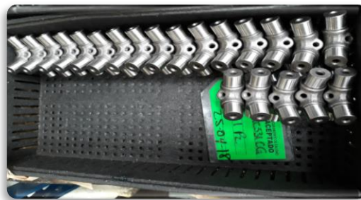
Figura 47. Piezas dentro de especificaciones identificado con tarjeta verde. Fuente: Elaboración propia
