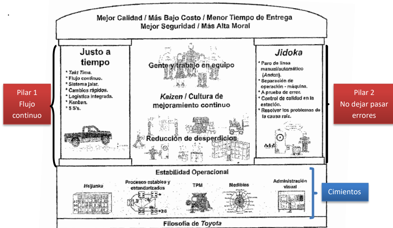
Figura 5. Representación de Casa del sistema de producción Toyota. Fuente: Alberto V, Lean, Guía básica, 2007
