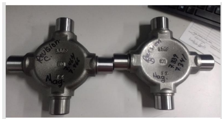
Figura 85. Crucetas probadas en torno Mazak con los nuevos herramientas. Fuente: Elaboración propia
