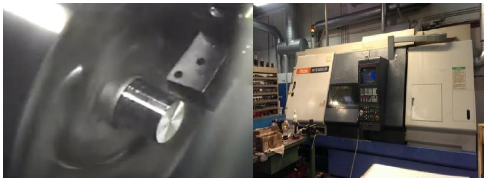
Figura 24. Proceso de desbaste de muñón en torno CNC "MAZAK". Fuente: Elaboración propia
