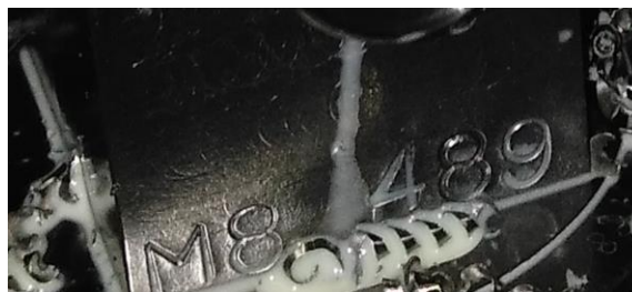
Figura 99. Marcado laser de número de parte y familia en herramienta de máq. Mazak. Fuente: Elaboración propia
