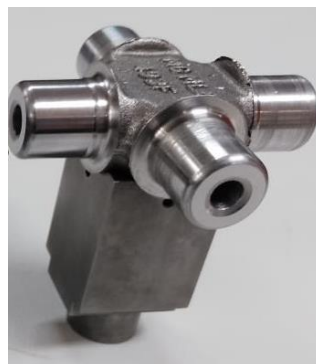
Figura 80. Cruceta colocada sobre una base (herramental Mazak). Fuente: Elaboración propia
