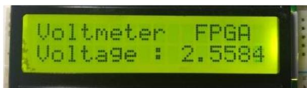
*Figura 5.53 Pantalla LCD desplegando el valor del voltaje medido en el potenciómetro.*
