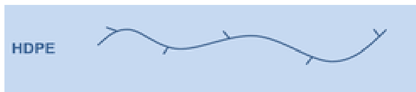
Figura 2.9 Ramificación del polietileno de alta densidad. [5]
