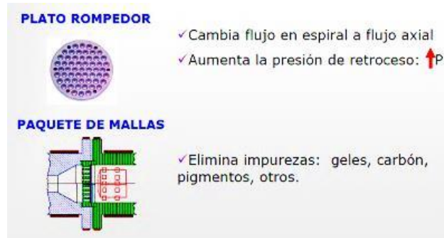
Figura 3.4 Plato Rompedor y Paquete de Mallas. [13]
