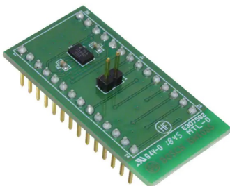
Figura 6.17: IMU seleccionada: IMU BOSCH BMI085 6-DoF 16
