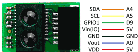
Figura 6.21: Sensor infrarrojo seleccionado: GP2Y0E03 18
