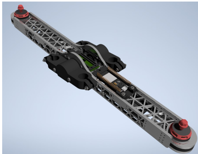
Figura 6.26: Ensamble CAD del balancín y componentes
