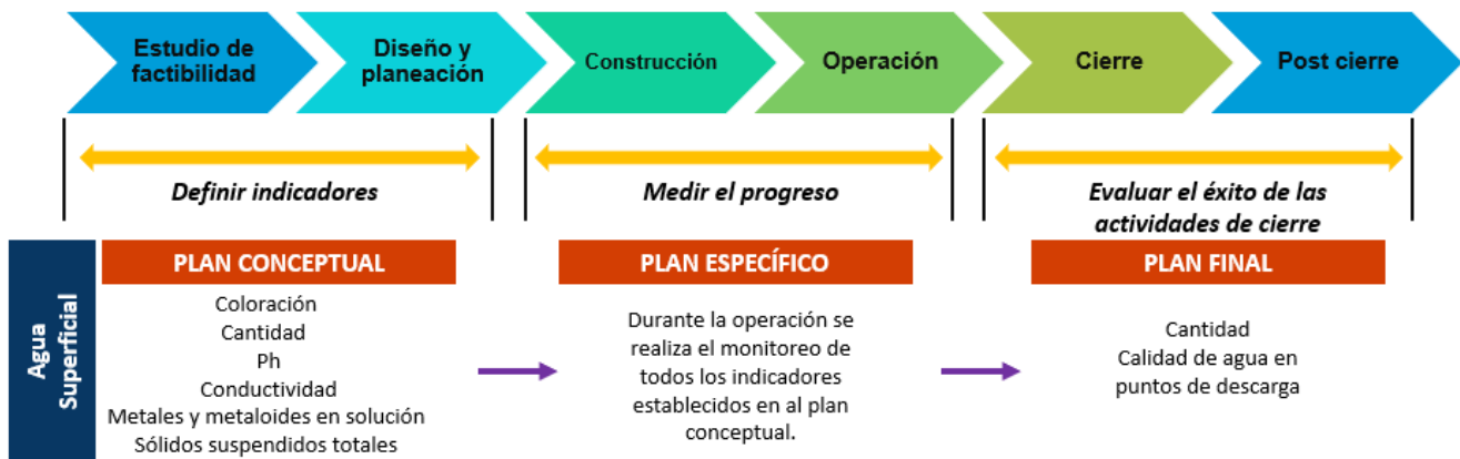
Figura 49. Ejemplo del uso de indicadores para monitorear aguas superficiales en una presa de jales.
