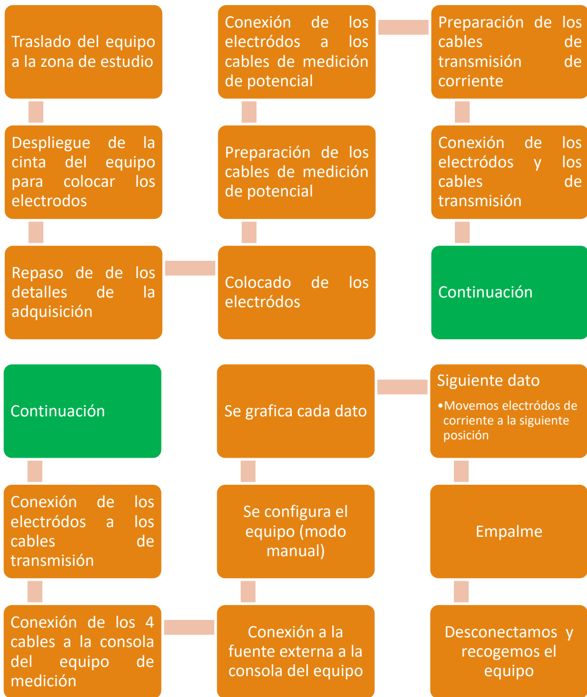
Figura 68. Proceso general del empleo del equipo en la exploración geoelectrica en 1D.
