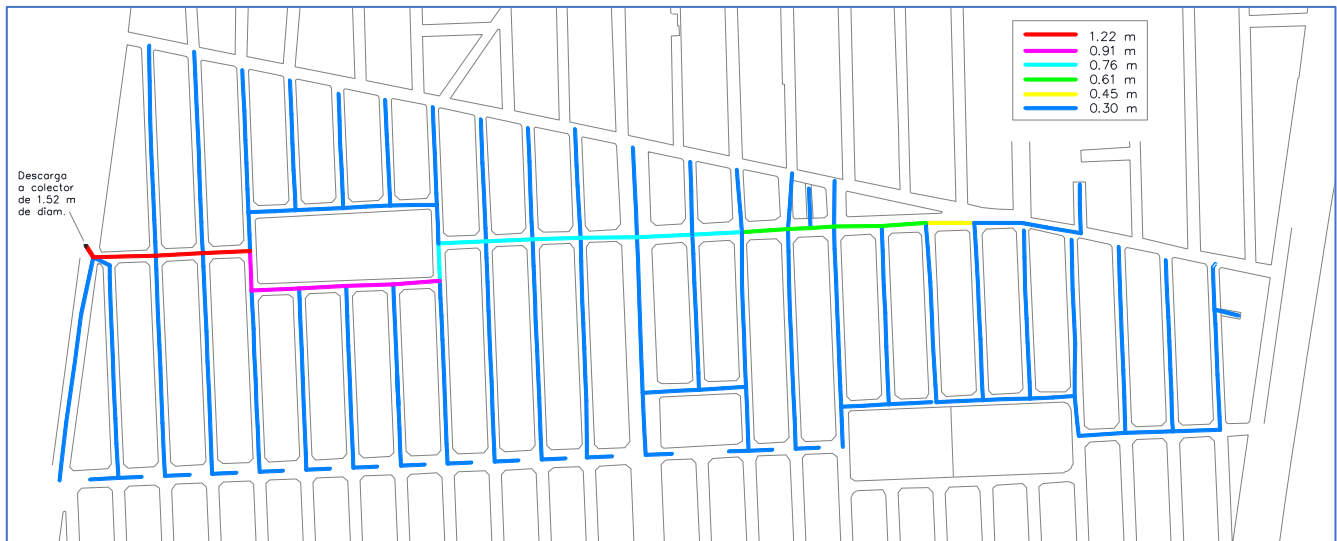
Figura 20. Tuberías del sistema de drenaje combinado de la cuenca de estudio
