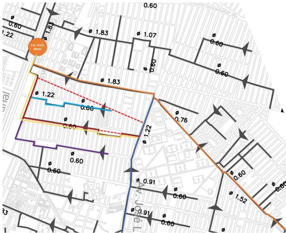
Figura 21. Sistema de colectores de la cuenca urbana mayor que descarga a P.B. Pozo Indio (SACMEX)
