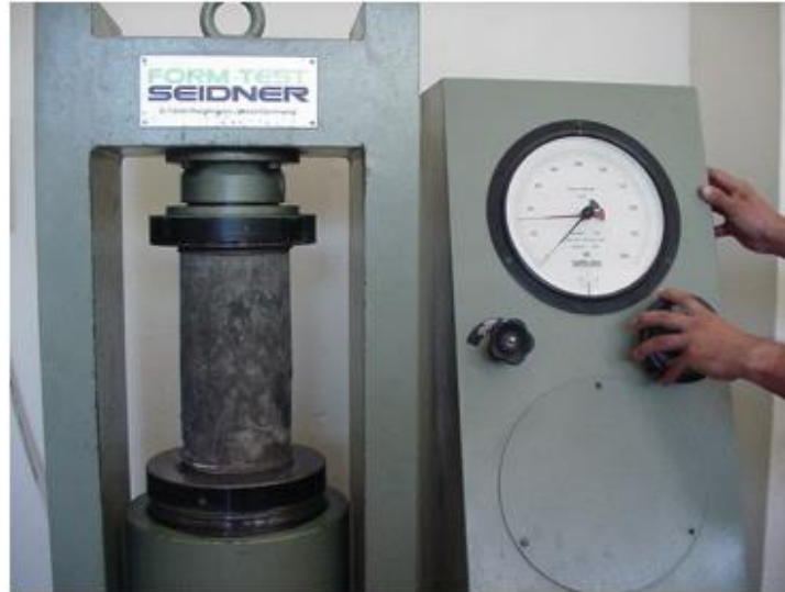
Fig. 1.4 Ensayo de la resistencia a la compresión del concreto
