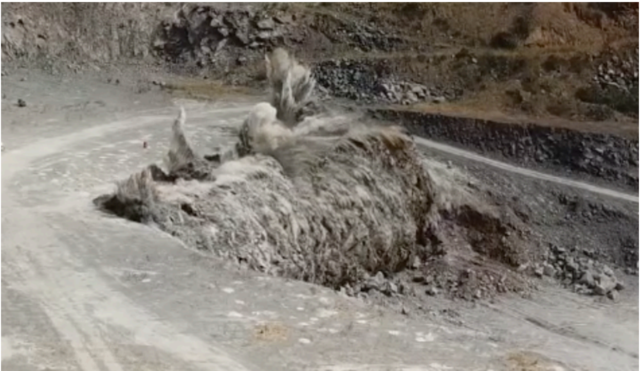
Figura 3 Voladura en proceso, realizada en una mina de agregados pétreos. Fuente propia.
