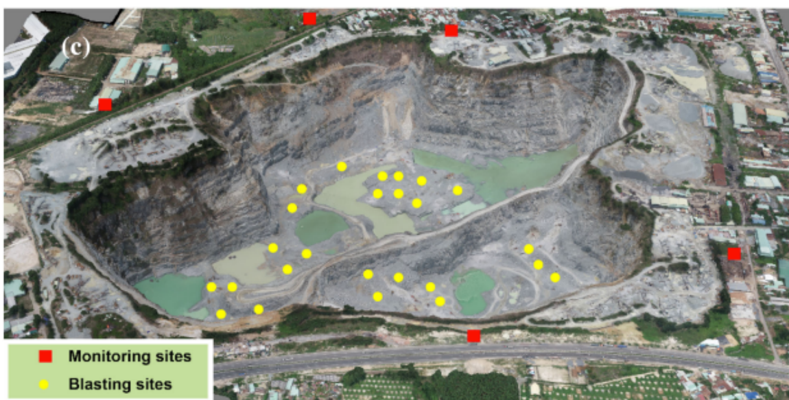
Figura 9 Modelo topográfico de la zona de estudio, así como la ubicación de los sismógrafos [6].
