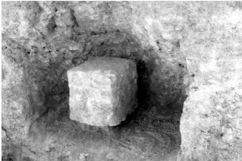
Figura 1. Obtención de una muestra para pruebas de laboratorio.
