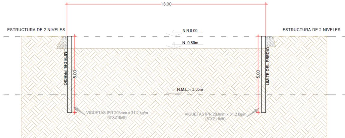
**FIGURA 30. COLOCACIÓN DE VIGUETAS METÁLICAS IPR 8” x 21lb/ft**
