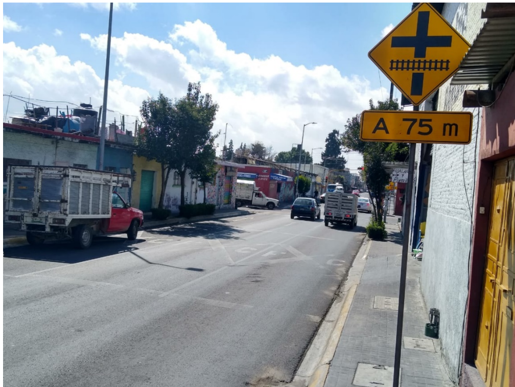
Fotografía 10. Señalamiento vertical en cruce a nivel ferroviario.
