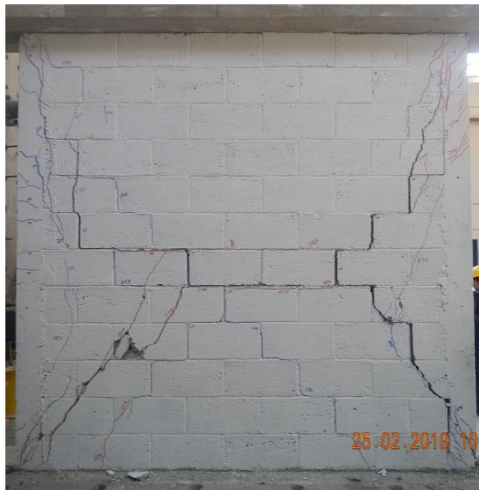
Figura 5.2 Patrón de agrietamiento final y curva de histéresis MBC-1
