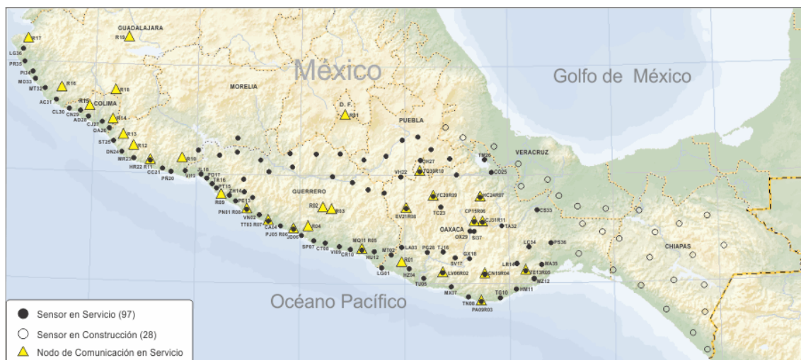
Figura 25. Mapa con los sensores sísmicos, sensores de servicios y nodos de comunicación:
