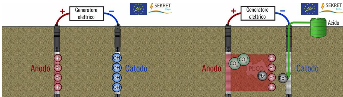
Figura 17: Esquema del método de electrorremediación. Izquierda: electrólisis del agua y carga de los electrodos en el suelo. Derecha: avance del frente ácido y movimiento de los iones hacia los electrodos. Fuente: Life SEKRET, 2016.
