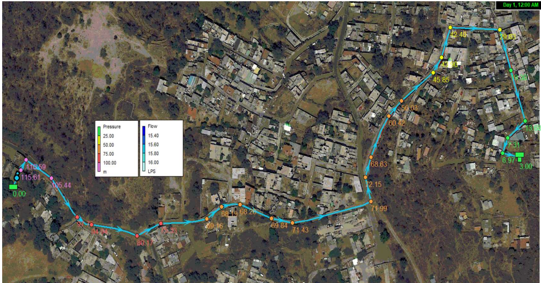
Figura 44. Modelación Hidráulica utilizando Software EPANET 2.0 simulando la línea de conducción de 6 pulgadas (152 mm) de diámetro de la Colonia Tecacalanco.
