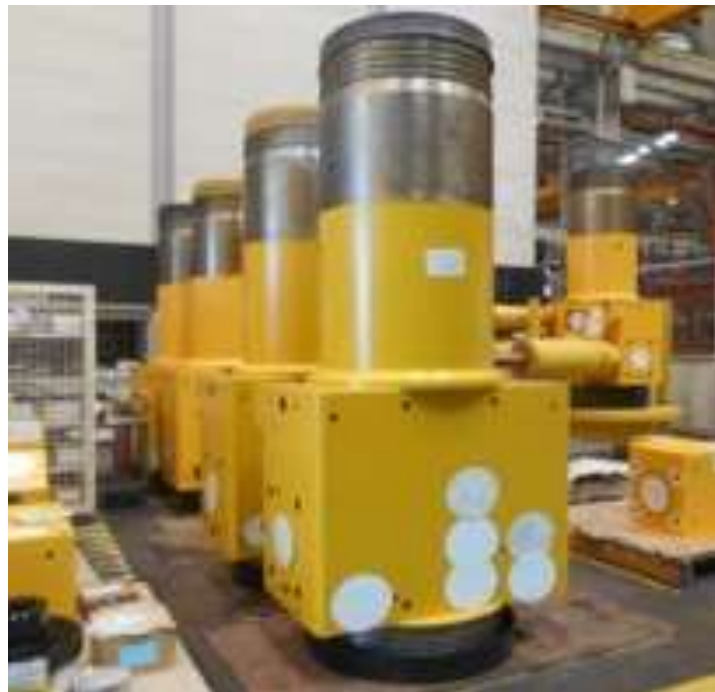
Figura 4.2 Resultado de la forja del árbol 47
