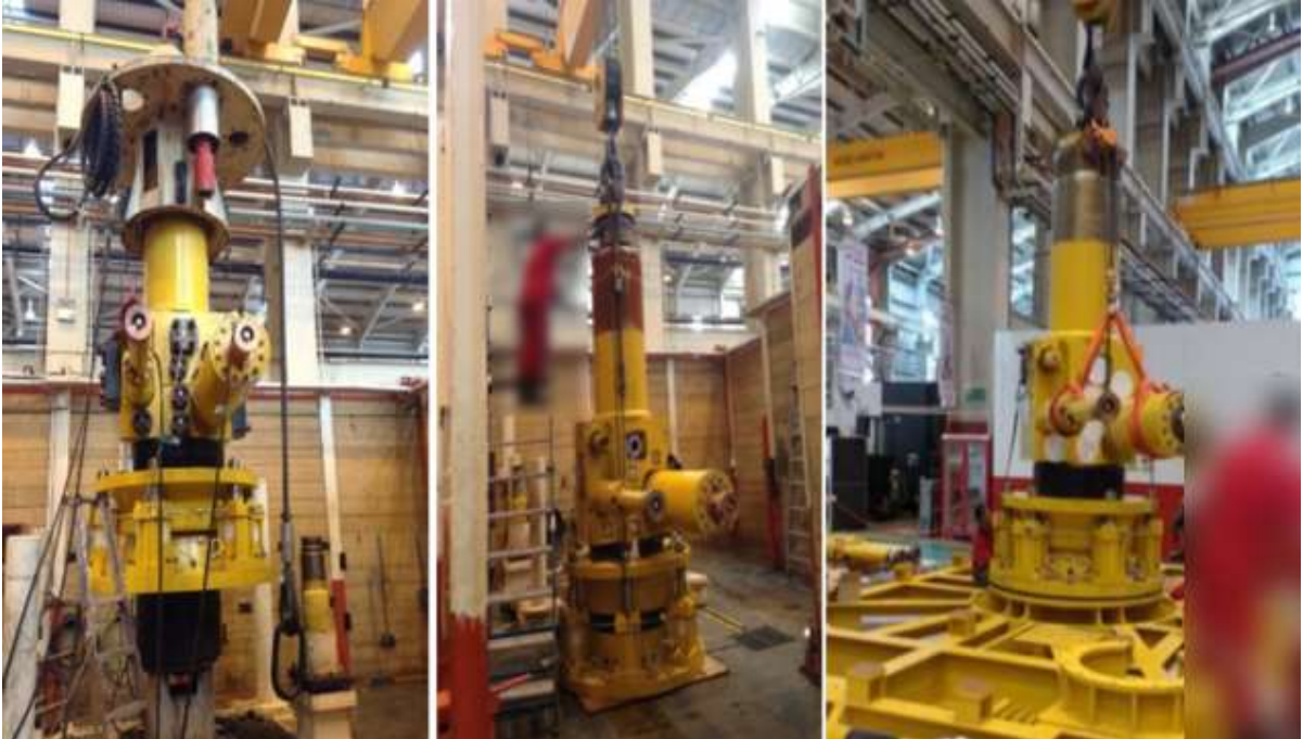
Figura 4.10 Instalación de las válvulas PMV y AMV en el Spool Body 55
