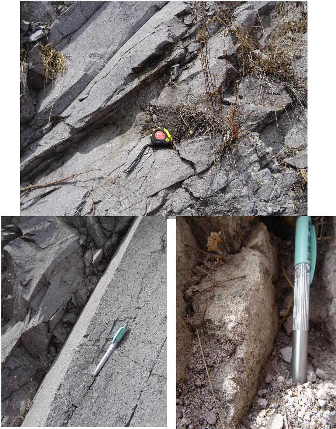
*Figura 15. Condiciones de las discontinuidades a diferentes escalas.*
