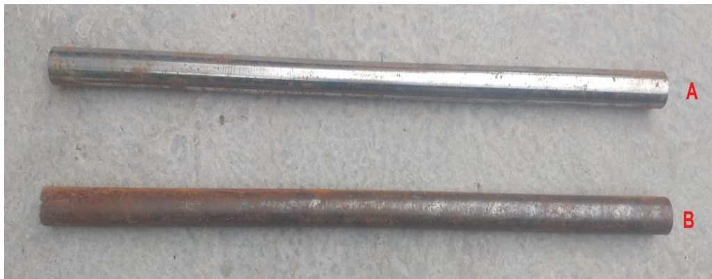
Figura 73. Redondos de acero A. SAE1018, B. SAE 1045. Diámetro de 2" y longitud de 1.5 [m].
