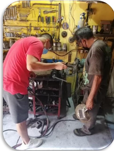
Imagen 26. Corte de rebabas de bisagras para unir con soldadura.
