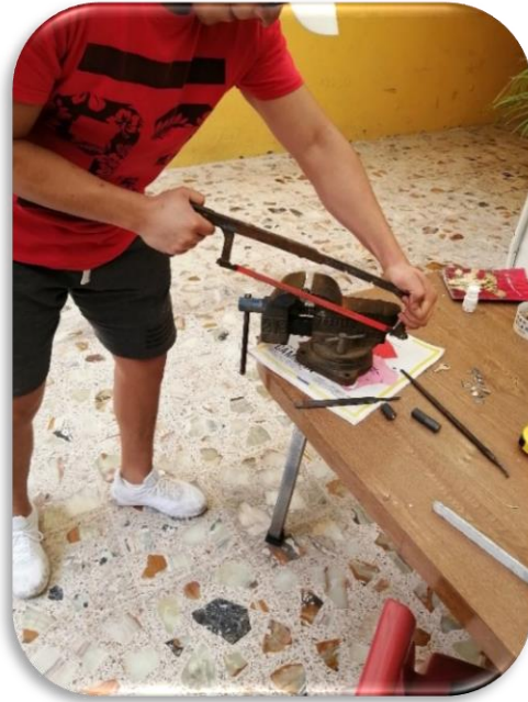
Imagen 26. Corte de rebabas de bisagras para unir con soldadura.
