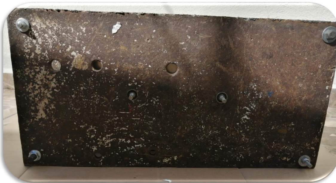
Imagen 57. Placa de acero con ensamble de ejes y pernos de seguridad en las esquinas.
