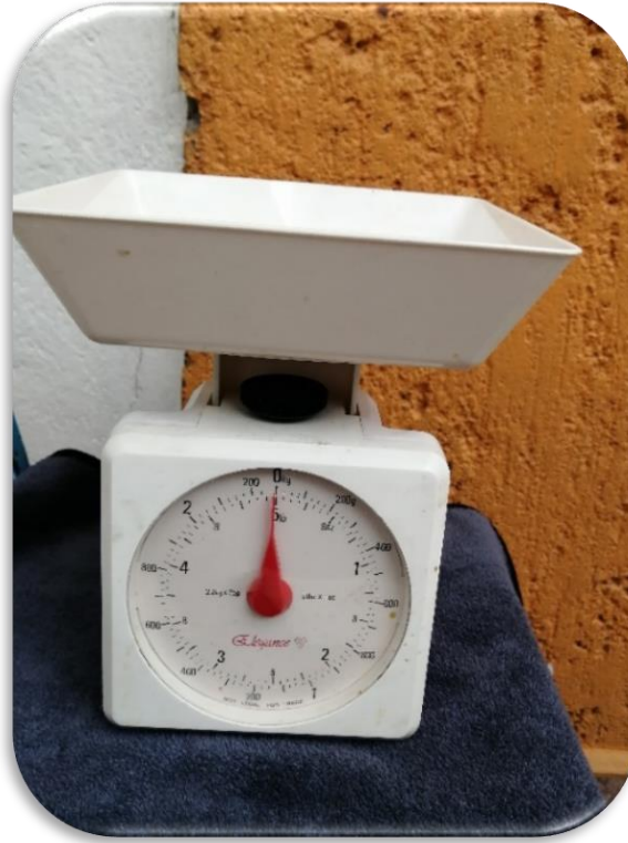
Imagen 17. Báscula previamente calibrada, utilizada para realizar pesaje.
