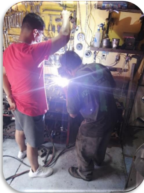
Imagen 27. Unión de varillas y bisagras al ángulo de acero con soldadura y recubrimiento con pintura en aerosol color gris.
