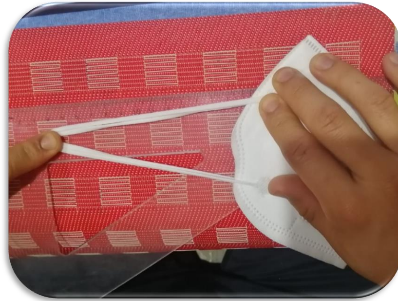
Imagen 25. Elongación máxima de la liga de sujeción del cubrebocas KN95 (24 cm).
