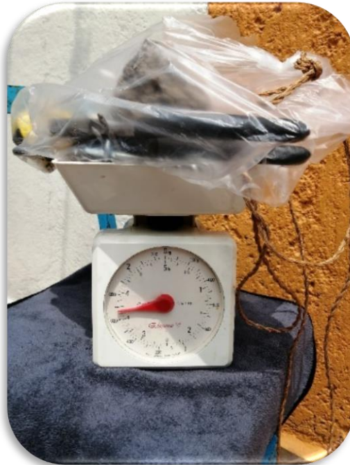
Imagen 19. Peso necesario para separar cordón elástico (1.675 kg).
