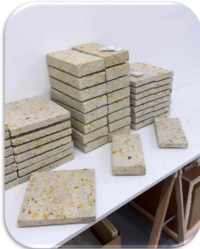
Imagen 14. Ladrillos fabricados a partir de residuos textiles. Fuente: portal-ambiental.com (2022). “Joven inventó ladrillos aislantes y resistentes al fuego a partir de ropa vieja”. Recuperado de: https://portal-ambiental.com/ecologia/joven-invento-ladrillos-aislantes-y-resistentes-al-fuego-a-partir-de-ropa-vieja/ .
