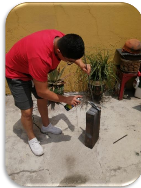
Imagen 27. Unión de varillas y bisagras al ángulo de acero con soldadura y recubrimiento con pintura en aerosol color gris.
