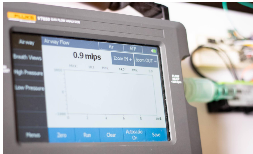
Figura 8.1 Analizador de flujo Fluke VT650 para calibración
