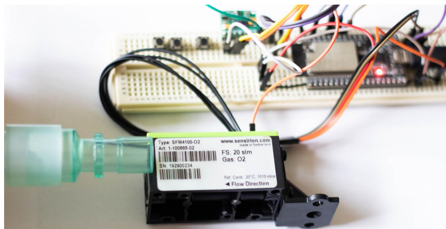
Figura 8.2 Configuración “en serie” del sensor de flujo y analizador (puerto azul)
