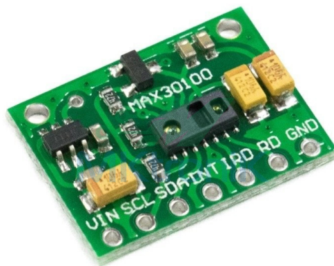
Figura 4.2 Sensor pulsioxímetro MAX30100 [24]
