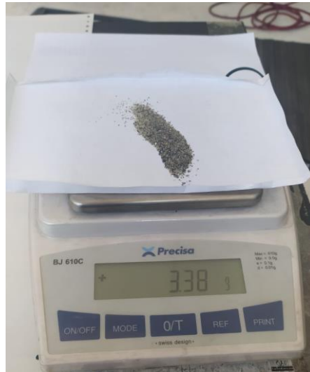
Imagen 8. Medición de los granos contenidos por tamiz.
