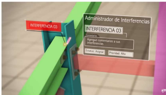
Figura 4.16 – Detección de una interferencia, entre la columna y la viga de acero, a la cual se asocian comentarios, responsables y prioridad de la interferencia [Tekla Software, 2016].
