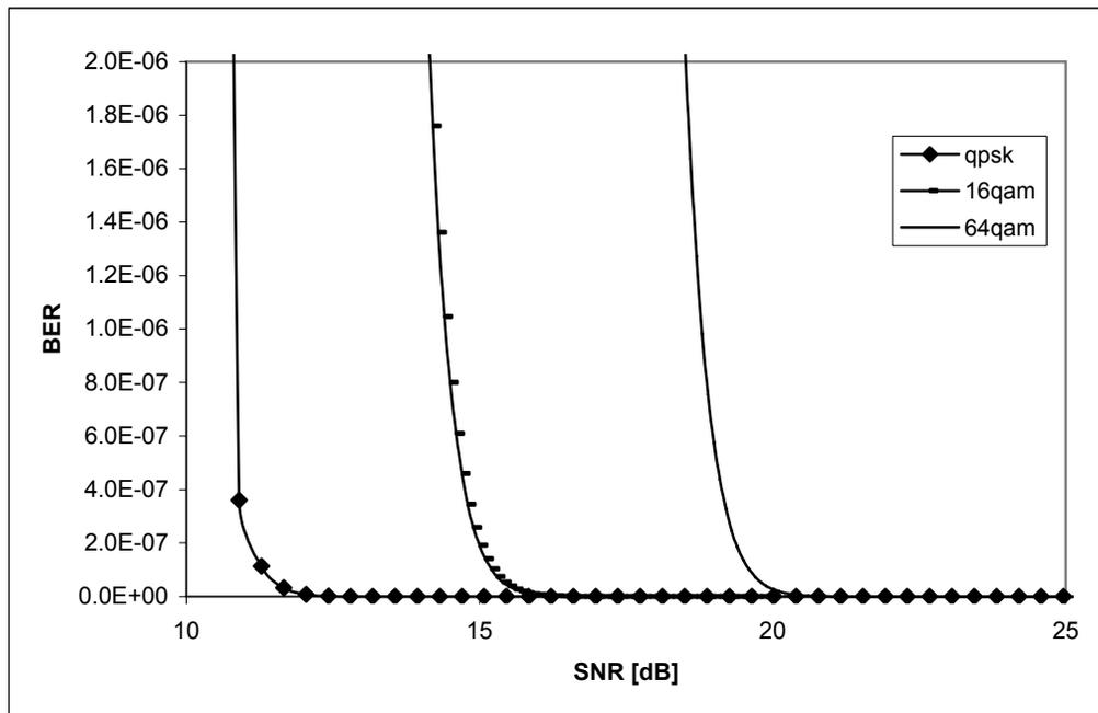
Figura 3 Gráfica del BER en función del SNR.
