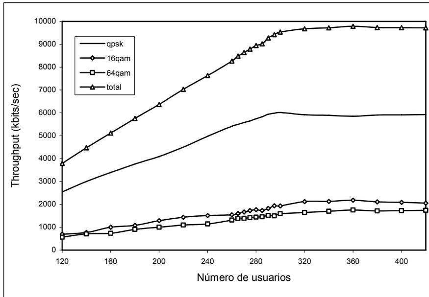
Figura 9 Throughput en la red con modulación adaptiva.
