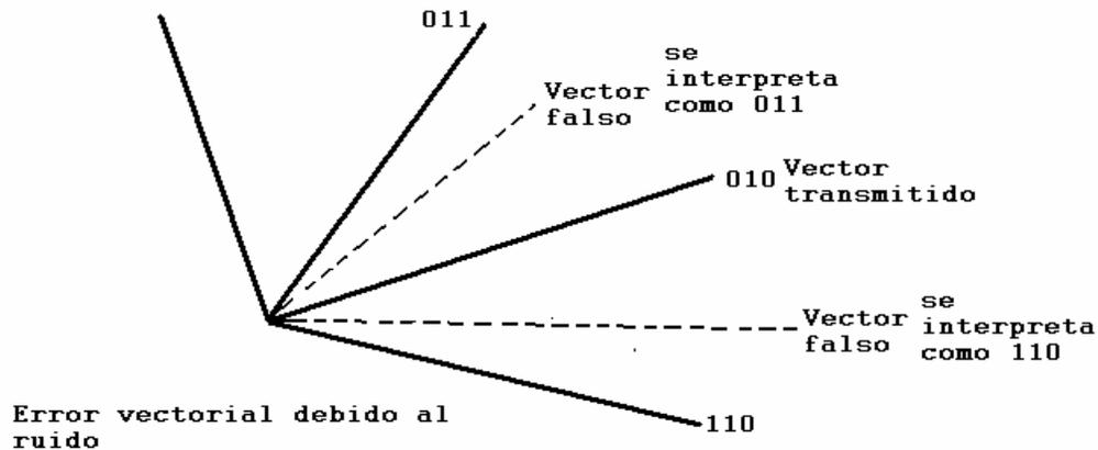
Figura 5 Representación de un error en QAM.
