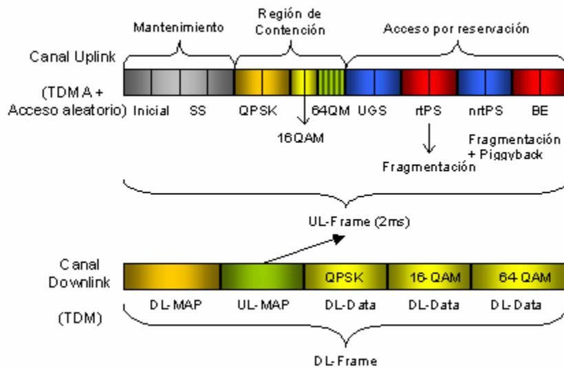
Figura 3 Estructura de los canales UL y DL.
