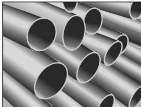
Figura 8.16. Acero inoxidable. Debido al contenido de 10-12 % de contenido de cromo, éste inhibe la corrosión provocada por el ambiente, al reaccionar con el oxígeno y formar una película pasivadora en la superficie de la tubería.
