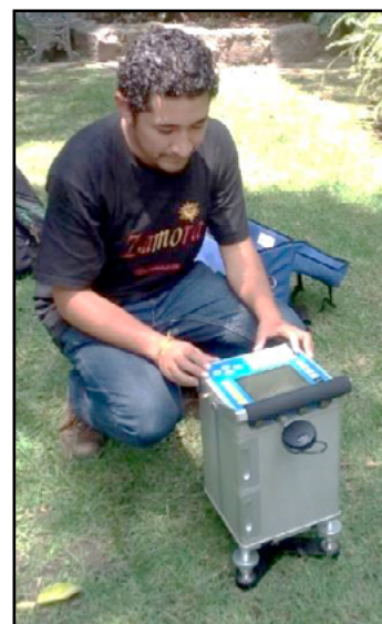
Figura 19.3. Toma de datos con gravímetro. Modelo CG-5 AUTOGRAV.
