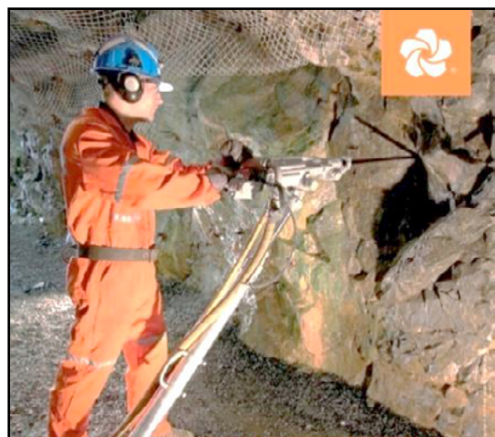
Figura 18.5. Máquina perforadora neumática modelo S250 marca Boart Longyear.
