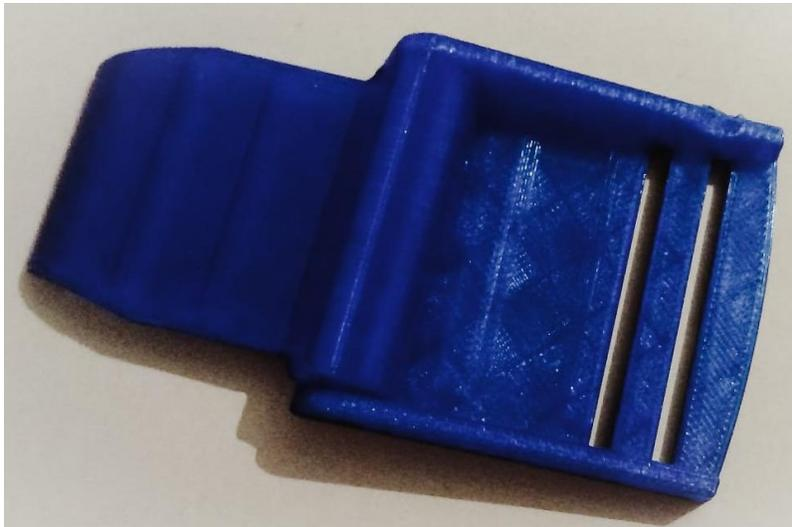
Figura 6.2 Ensamble del broche, impreso en 3D con filamento de PLA.
