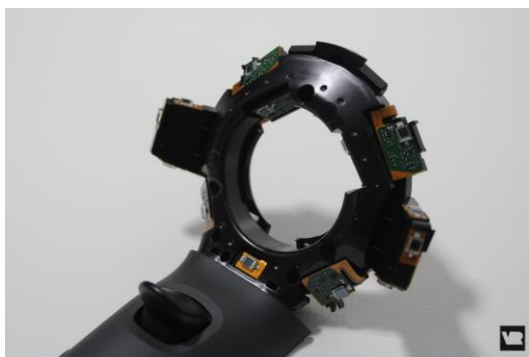
Figura 73. Sensores ASIC de los controles del sistema HTC Vive.
