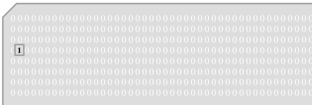
Figura 41. Representación simple del stencil buffer.
