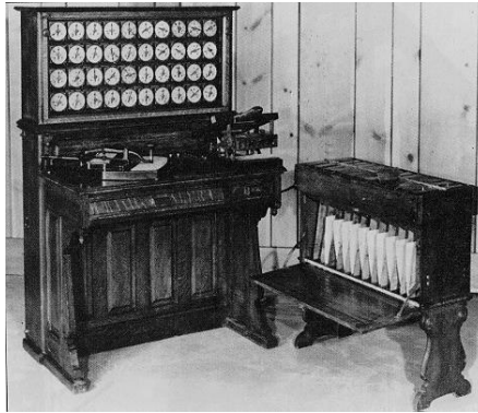
Figura 3. Máquina tabuladora de Hollerith de 1890.
