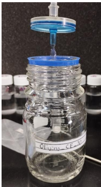
Figura 12 Proceso de filtración del agua recuperada para la muestra Olivino_CE_30 posterior al tiempo de exposición con dióxido de carbono para realizar su análisis por ICP-OES
