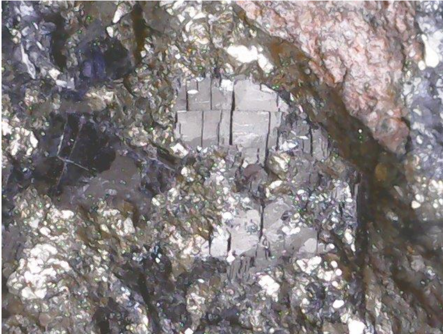
Fig. 42 (lupa, 10x). Cristales de galena entre la esfalerita-pirita. La galena solo es distinguible en zonas muy locales.
