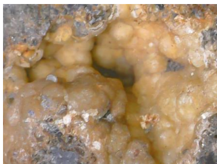
Fig. 47 (lupa, 10x). Probable mimetita en agregados botroidales.
