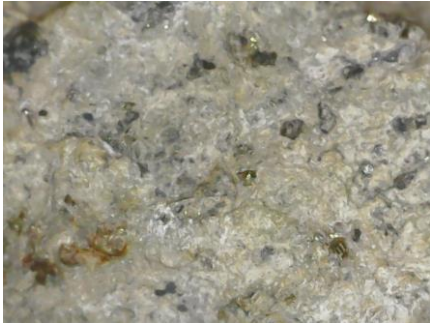
Fig. 35 (lupa, 10x). Cerusita, principal componente de la muestra. Fig. 36 (lupa, 10x). Cristales de cuarzo con pirita.
