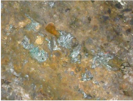
Fig. 52 (lupa, 10x). Calcoaurita (tonos turquesa). Fig. 53 (lupa, 10x). Óxidos de hierro. Confirma sin lugar a duda la presencia de zinc por lo que da seguridad para determinar a la hemimorfita y para inferir a la esfalerita.
