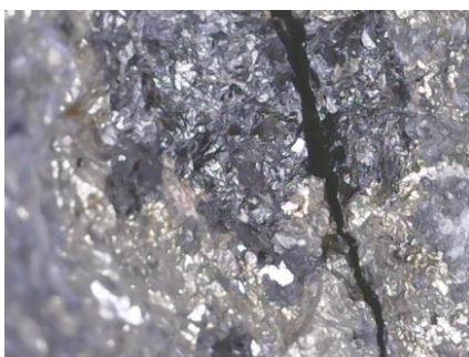
Fig. 40 (lupa, 10x). Se observa la asociación entre la pirita-esfalerita y el cuarzo.
