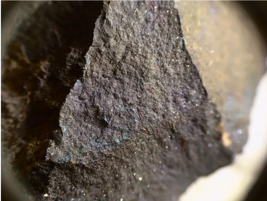
Fig. 21 (lupa, 10x). Se observa la composición monomineral y la textura de la muestra. Esta zona fotografiada es representativa de la zona 'expuesta' de la muestra.
