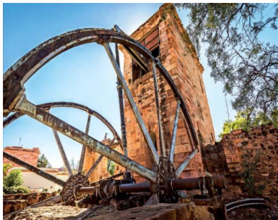
Fig. 4. Uno de los dos motores de vapor Harvey & Co. Sigue presente en Fresnillo y, el par, representan los únicos ejemplares en territorio mexicano. Tomada de Escuelas de Minas Mexicanas , Escamilla O. (2017, UNAM).
