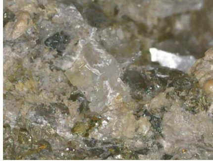
Fig. 35 (lupa, 10x). Cerusita, principal componente de la muestra. Fig. 36 (lupa, 10x). Cristales de cuarzo con pirita.
