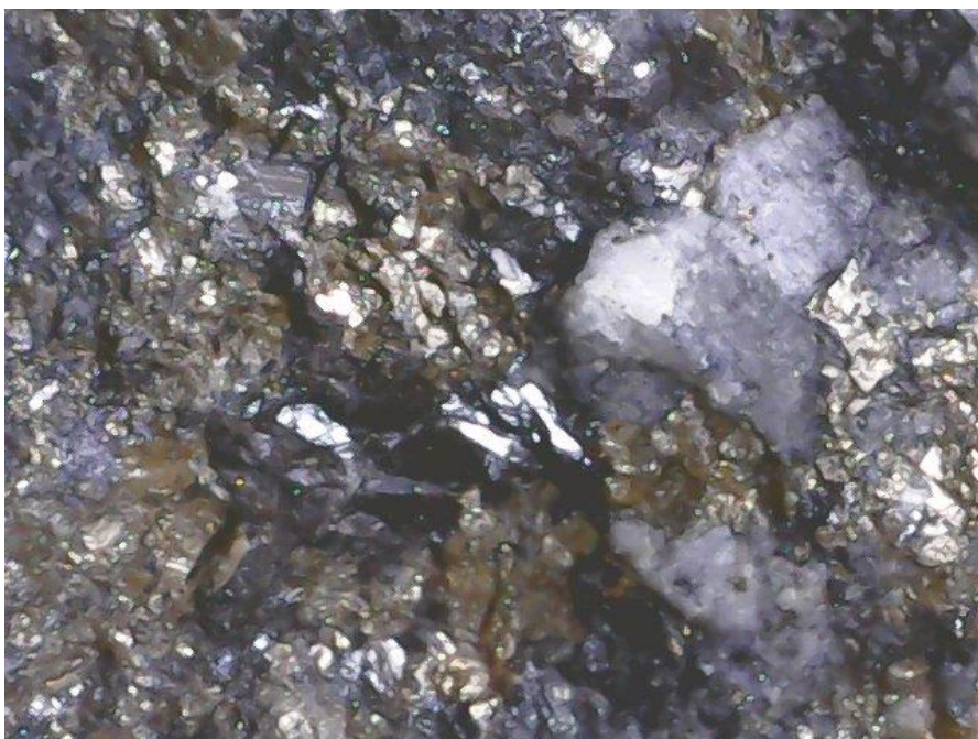
Fig. 40 (lupa, 10x). Se observa la asociación entre la pirita-esfalerita y el cuarzo.
