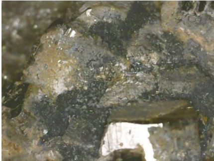
Fig. 58 (lupa, 10x). Cristales de marmatita sobre cristales euedrales de pirita.
