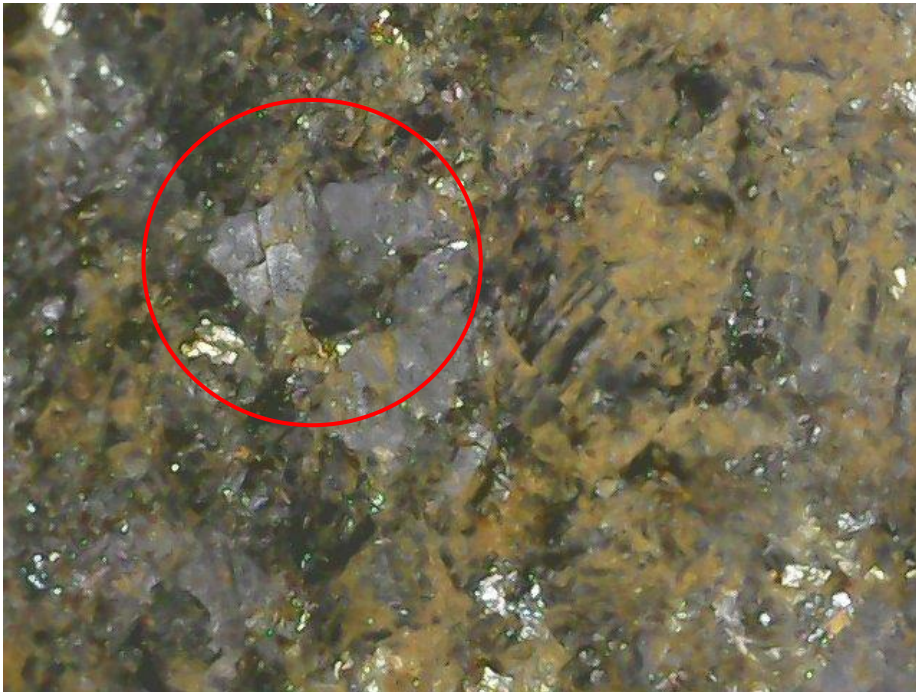
Fig. 60 (lupa, 10x). Galena, se observa asociada a la etapa de esfalerita-pirita, pero en menor proporción.
