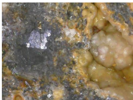
Fig. 49 (lupa, 10x). Cristal de galena (aquel que refleja la luz en un tono gris claro).
