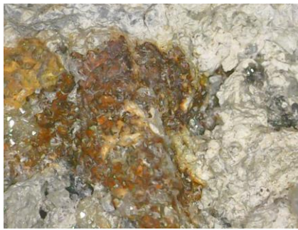
Fig. 37 (lupa, 10x). Masicot que recubre a la cerusita, se presentan algunos cristales de pirita. Fig. 38 (lupa, 10x). Óxidos de hierro en zonas locales de la muestra.
