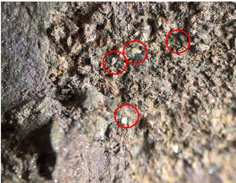
Fig. 27 (lupa, 10x). Zona 'terrosa' con cristales. Se señalan en círculos rojos aquellos cristales de cuarzo libres de hematita.
