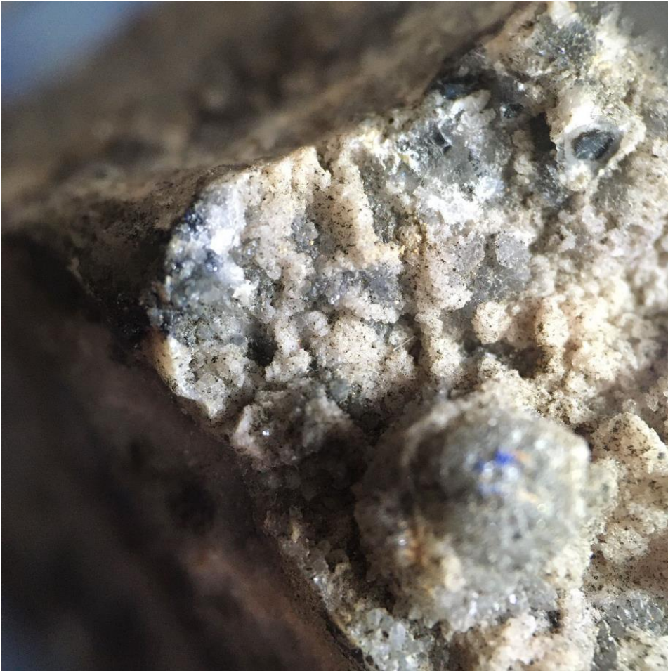
Fig. 33 (lupa, 10x). Carbonatos que dan un aspecto de enrejado alrededor de cristales de esfalerita. Se observa en un extremo de la muestra una mancha color azul rey (posible azurita).
