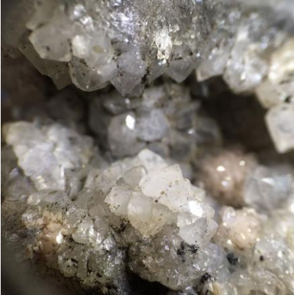
Fig. 30 (lupa, 10x). Cuarzo macrocristalino en una cavidad entre los fragmentos de roca.
