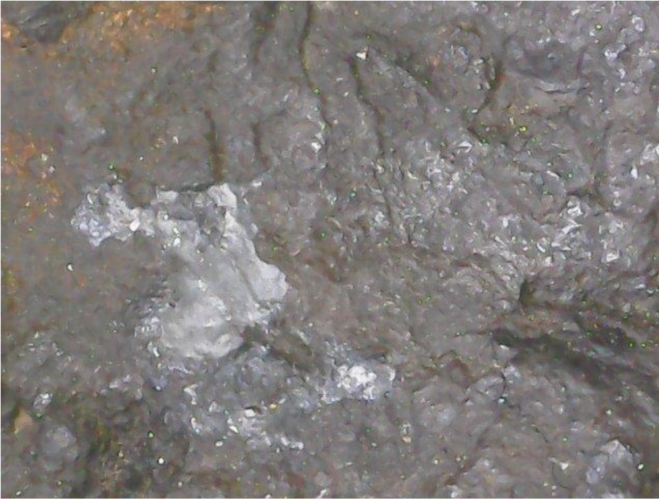
Fig. 55 (lupa, 10x). Romanechita, se aprecian óxidos de hierro en la esquina superior izquierda.
