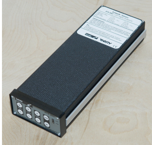
Figura 2.9: Acondicionador de señal para el LVDT.
