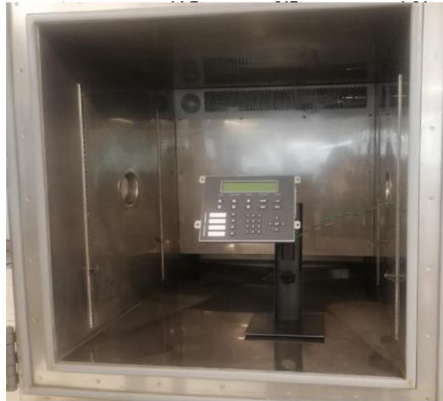
Figura 17. Instalación de panel en la cámara de simulación de temperatura
