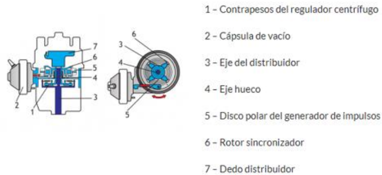
Figura 4 Distribuidor con sistema sensor inductivo. 4
