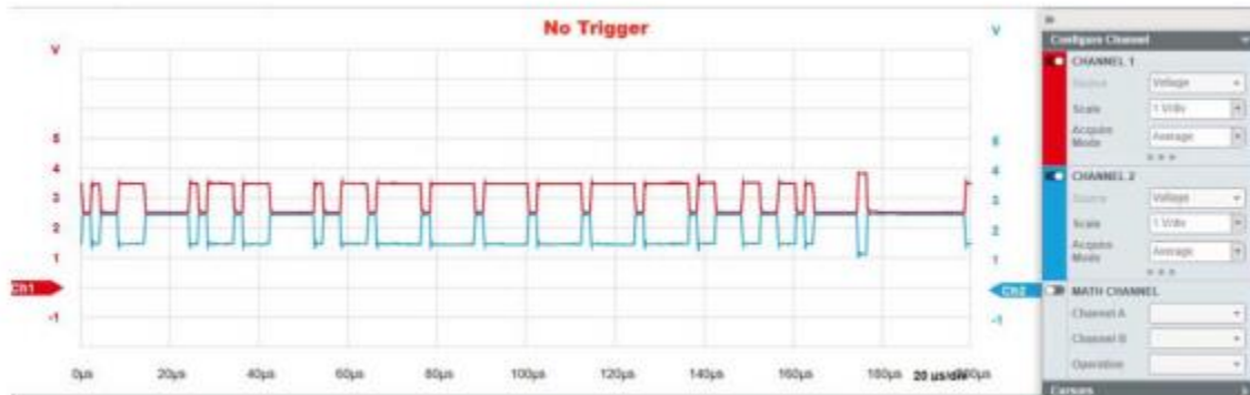
Figura 9 señal de osciloscopio de una red CAN. 9
