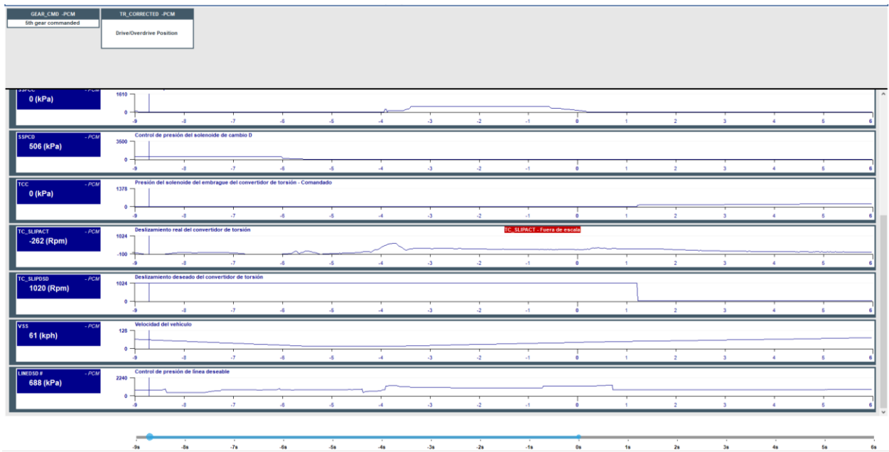
Figura 17 PIDs con falla de deslizamiento del convertidor de par. 17
