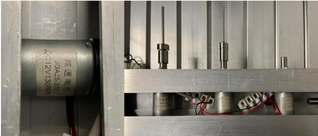
Figura 23. Motorreductores JGA25-370.
