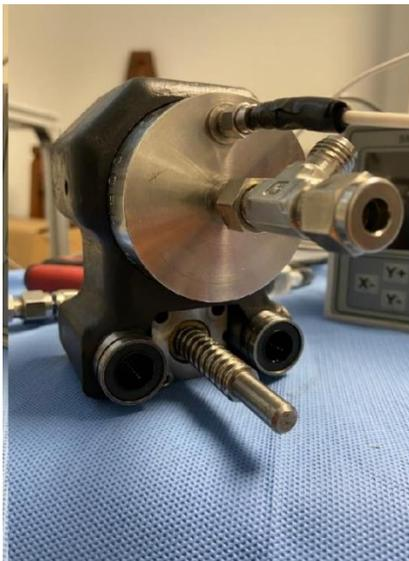
Figura 40. Soporte para la boquilla ultrasónica.
