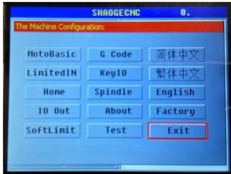
Figura 28. Menú configuración de máquina.
