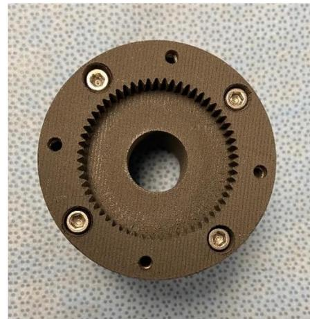
Figura 57. Impresión de caja con tornillos para acoplar a motor.
