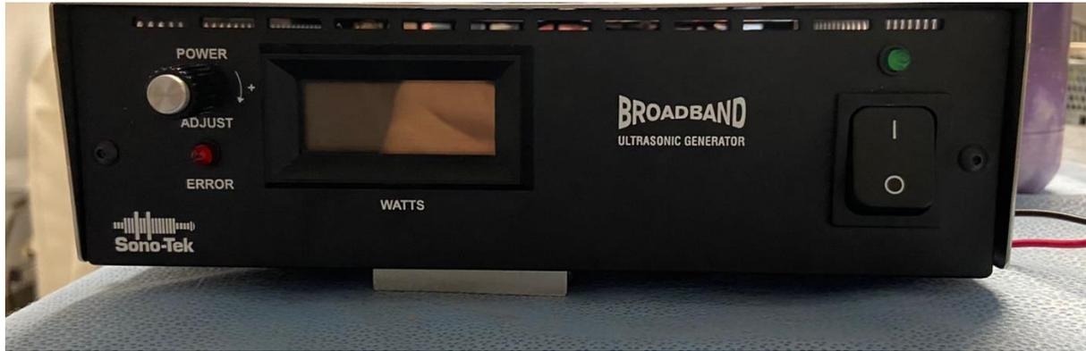
Figura 42. Generador de frecuencia para la boquilla ultrasónica Broadband.
