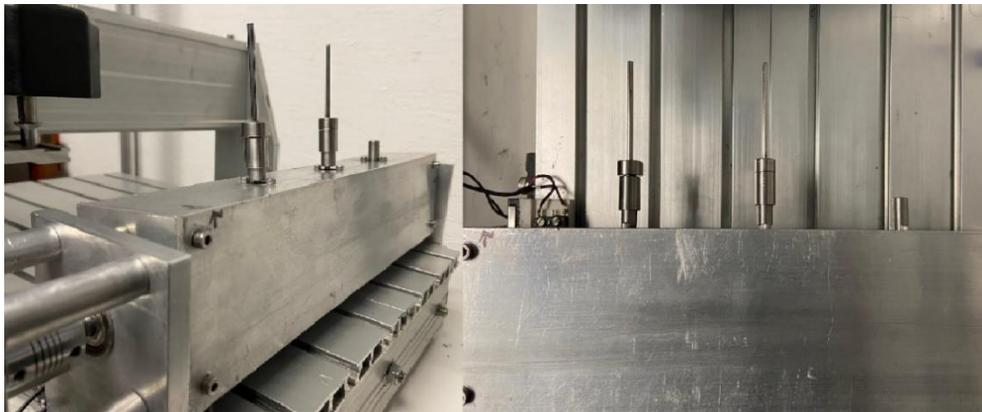
Figura 17. Soporte giratorio para Stents.
