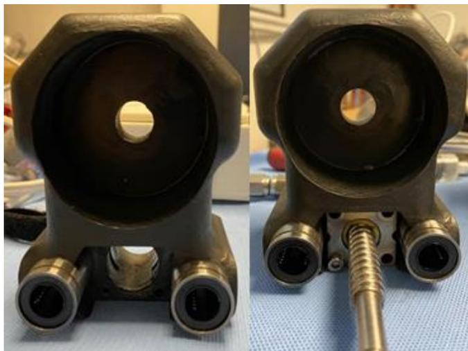
Figura 62. Diseño de soporte de boquilla ultrasónica con baleros lineales y con tornillo de esferas recirculantes.
