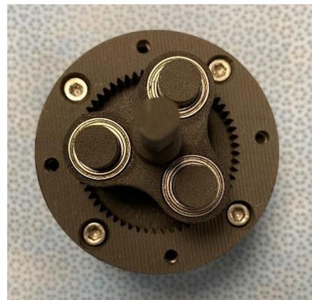
Figura 59. Sistema planetario armado sin tapa.
