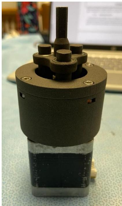
Figura 36. Adaptación de engranaje planetario para montarlo sobre un motor nema 17.
