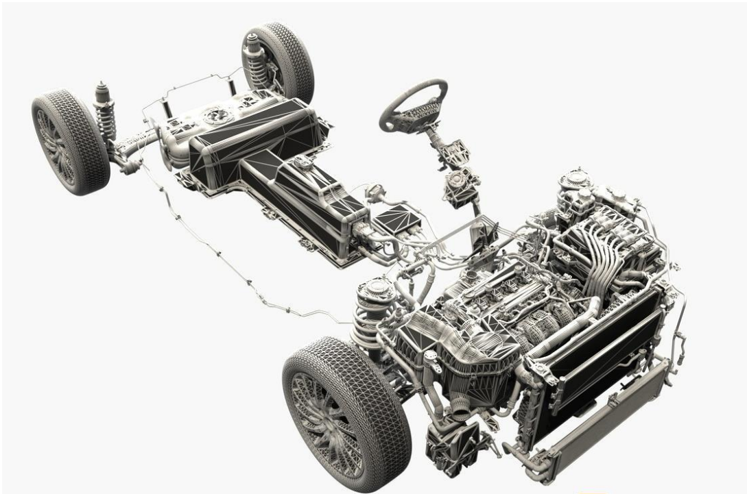
Figura 12: Líneas de frenado y de combustible de un vehículo virtual junto con otros componentes.
