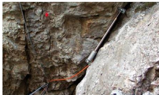
Ilustración 35. A. Extensómetro de cuerda vibrante eléctrica. Tomado de Geokon.com B. Supervisión de un talud rocoso durante la excavación con explosivos del Túnel de La Roche (Suiza) con extensómetro superficial (SOLOEXPERTS,2016)
