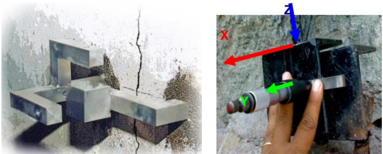
Ilustración 58. Tipos de medidores de juntas tridireccional. (Izq.) Tomado de Auscultación y Taller de Ingeniería S.A (Der.) Presentación Instrumentación Geotécnica 2020, Asignatura Geología Aplicada a la Ingeniería Civil.
