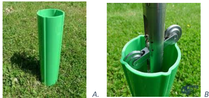
Ilustración 3. A. Tubería guía ABS. B. Introducción de sonda en tubería guía (Gouda Geo-Equipment B.V Inclinometers casing tubes)
