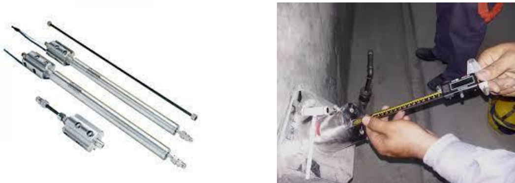
Ilustración 41. A. Extensómetro de barras interno de punto múltiple. Tomado de GEOKON.COM B. Toma de lecturas en un extensómetro de barras con un micrómetro. Tomado de Instituto de Investigaciones: idia.unsj.edu.ar
