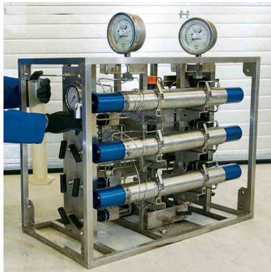
Figura 2.17: Ejemplo de un equipo para muestreo en cabeza de pozo, tomado de Schlumberger, s.f.-b
