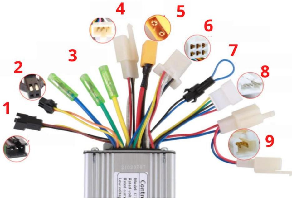
Figura 25 Referencia de conexiones del controlador KT 48V/500W. 1.- Sensor PAS, 2.-Luz delantera, 3.-Motor, 4.-Acelerador, 5.- Batería, 6.- Hall del motor, 7.- Función cruceo, 8.-Display, 9. Frenos. Imagen obtenida de Ali Express
