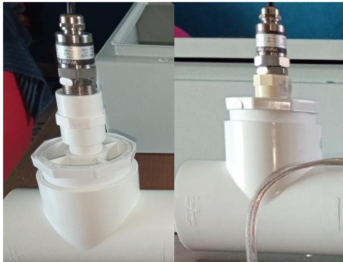
Ilustración 53 - Antes (izquierda) y después (derecha) del ensamble del sensor de presión.
