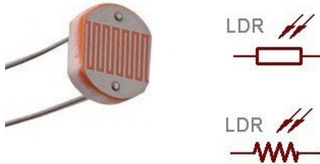
Figura 4.24 Celda de fotorresistencia y sus símbolos eléctricos [20]
