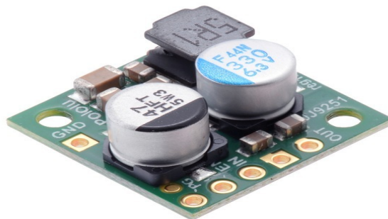
Figura 3.5: Regulador de voltaje de bajada Pololu [10]
