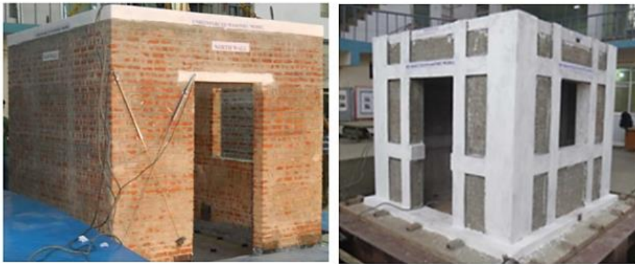
Figura 31. Modelo de mampostería simple (izq.) y modelo reforzado y confinado con malla de alambre soldado (der.) (Chellappa, 2018).
