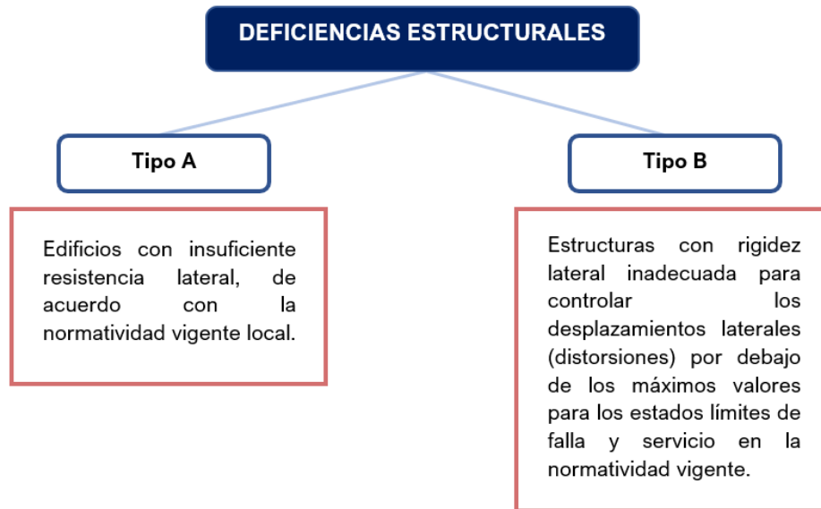
Figura 13. Esquema de deficiencias estructurales (INIFED, 2021a).
