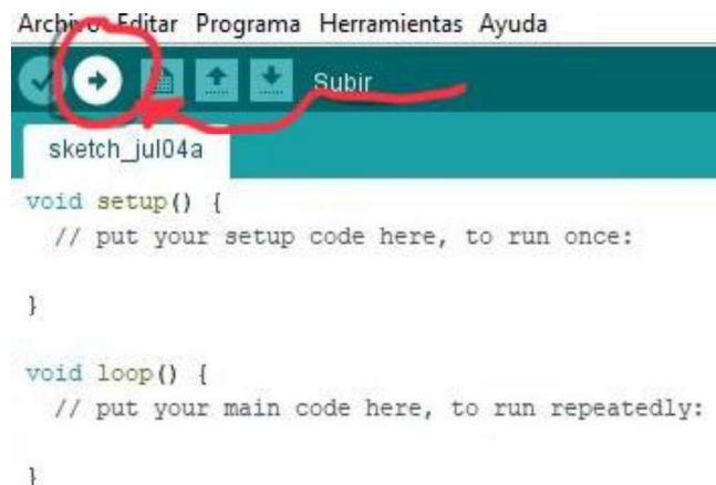
Figura 59: Paso 3. Carga de un programa a la tarjeta Arduino.
