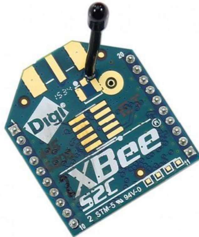
Figura 23: Radio Xbee S2C con antena Whip, obtenida de un sitio de compras “buyhatke!”[28] .
