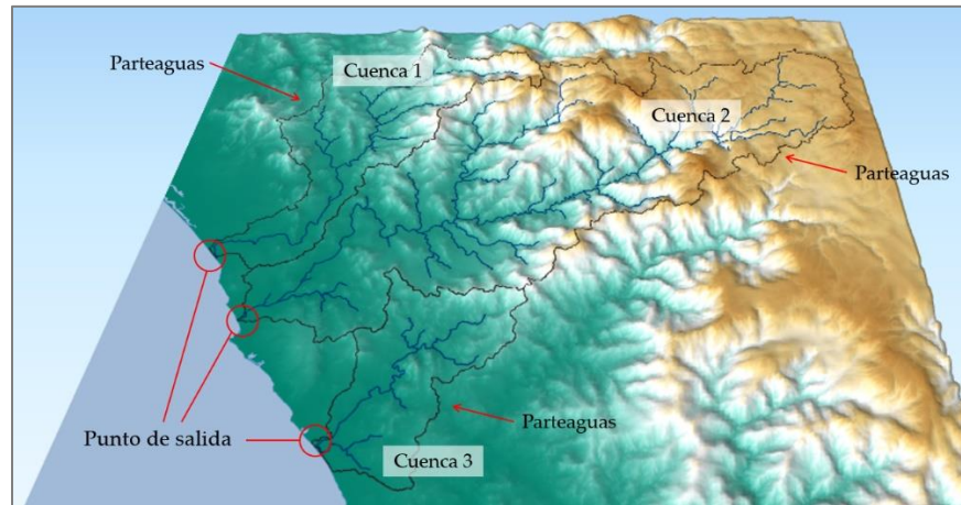
Figura 2. Parteaguas de cuencas hidrológicas según la topografía. Se muestran tres cuencas abiertas con descarga al mar, su parteaguas y redes de drenaje.
