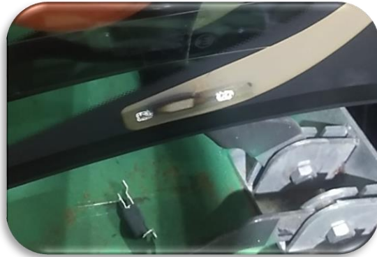
Fig. 26 Bobina de medallón desprendida.
