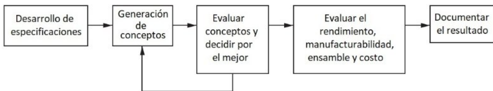
▲ Fig. 2.2 Proceso de diseño usado para los herramientas
