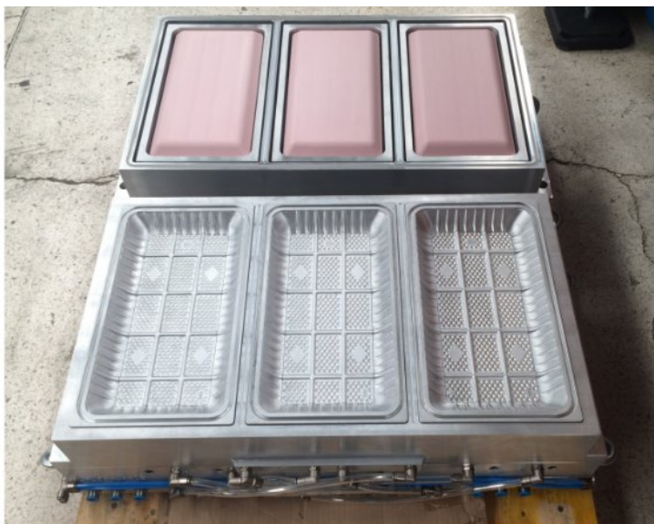
▲ Fig. 3.1 Vista actual del molde con insertos denominados “fondo con costillas” y contramolde con plugs
