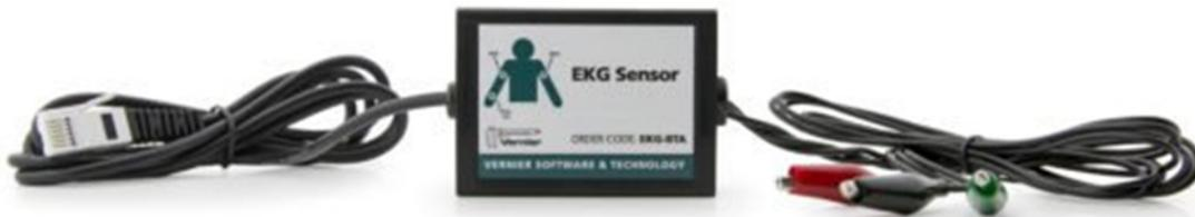
Figura 5.7: Sensor de ECG utilizado en las pruebas. Imagen tomada de:
