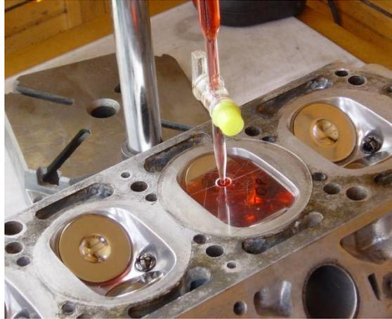
*Figura 4.3: Volumen de la cámara de combustión, por Wilder,J, 2017, <https://mecatronnix.blogspot.com/2018/05/culata-motor-rectificacion-planitud.html>*
