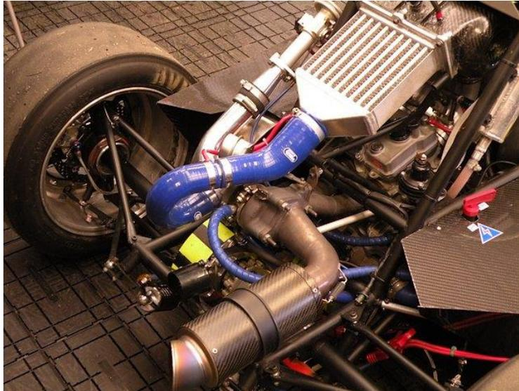
Figura 6.18: Segunda configuración de plenum de admisión con turbocargador [https://jonburford.carbonmade.com/projects/4357971]
