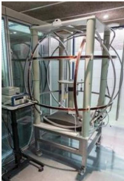
**Figura. 3. Simulador de campo magnético del NanoSat Lab.**
