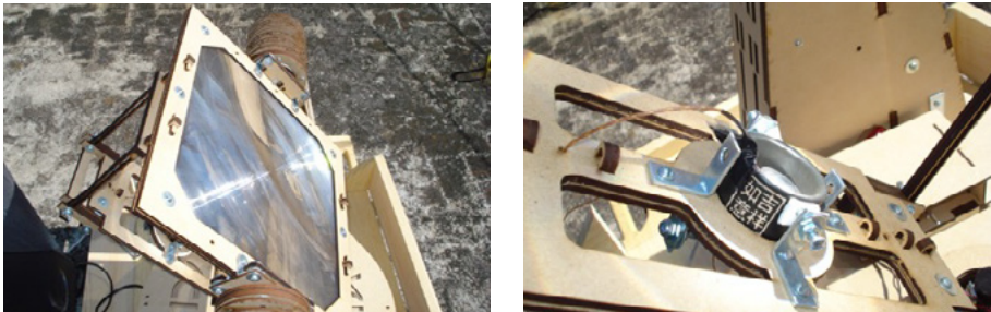
Figura 1(a) Vista del prototipo de lente Fresnel vista superior (b) Zona de concentración solar (en el foco) del concentrador por lente de Fresnel para realizar experimentos
