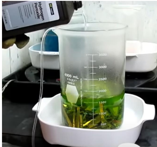
Figura 4.21. Tarjetas en mezcla ácida. (sreetips, 2015)
