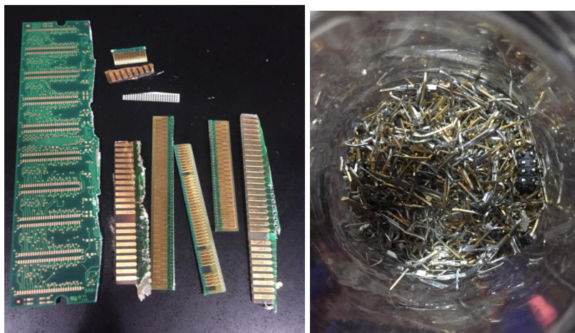
Figura 4.16. Pines desmontados, (Elaboración propia, 2021)
